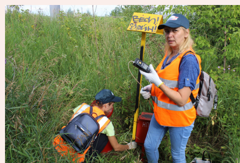
Для обнаружения утечки используем газоанализатор
